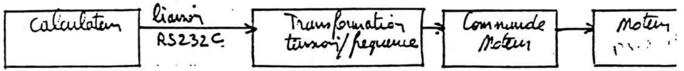
Le calculateur peut être n'importe quel microordinateur avec langage basic et possédant un port de liaison série RS
